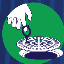
1) RETIRE A GRELHA DO RALO COM A CHAVE
